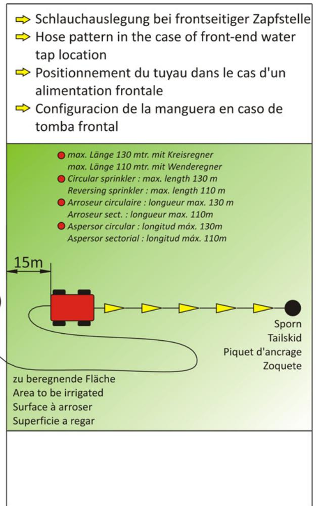
Damit der Schlauch nicht zu sehr belastet wird, sollte diese Schlauchauslegung unbedingt eingehalten werden. Zur Sicherheit ist am Mitnehmer der Seiltrommel eine Scherschraube montiert, welche bei zu hoher Zugkraft, wenn z.B. der Schlauch an einem Hindernis hängen bleibt, absichert. Dadurch ist gewährleistet, dass der Schlauch nicht beschädigt wird, bzw. der Sporn nicht aus der Verankerung gerissen wird. Bei Bedarf nur Original Abscherschraube verwenden.
